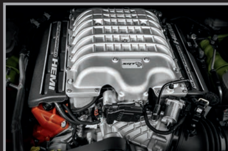
Motor HEMI® Hellcat® 6.2L V8 supercargado con 707 C.F. (Versión Hellcat)
