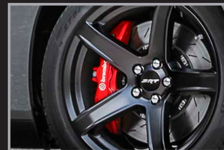
Frenos Brembo® de alto rendimiento con calipers de 6 pistones en color rojo
