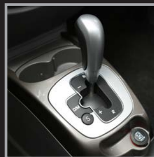
Transmisión manual o Dualogic de 5 velocidades
